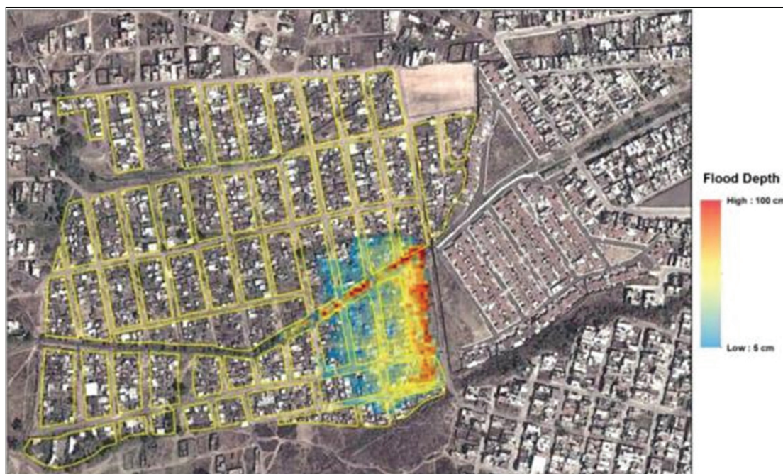
Figura 5. Modelo Lidar con escenarios de inundación en el área de estudio.
