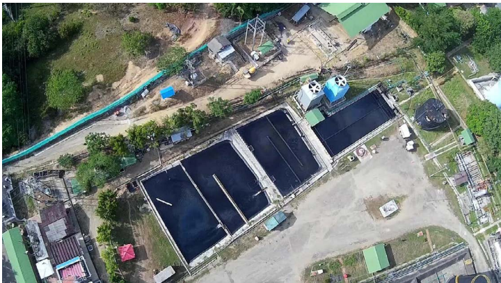
Foto 5. Imagen aérea de los pozos extractivos y las piscinas de lixiviados.
