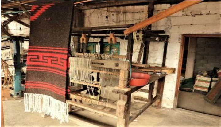
Foto 3. Antiguo telar de pedal para la elaboración de gabanes y cobijas. Nahuatzen, Michoacán. Junio de 2018. Autora: Laura Leticia Cervantes Naranjo.
