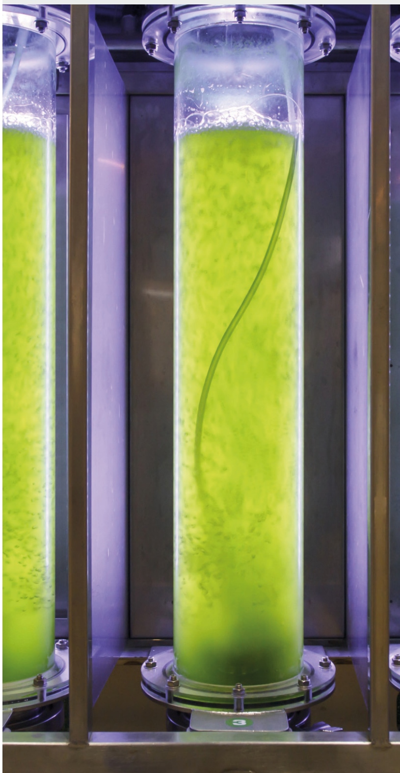
Carburante de algas en un fotobiorreactor.
