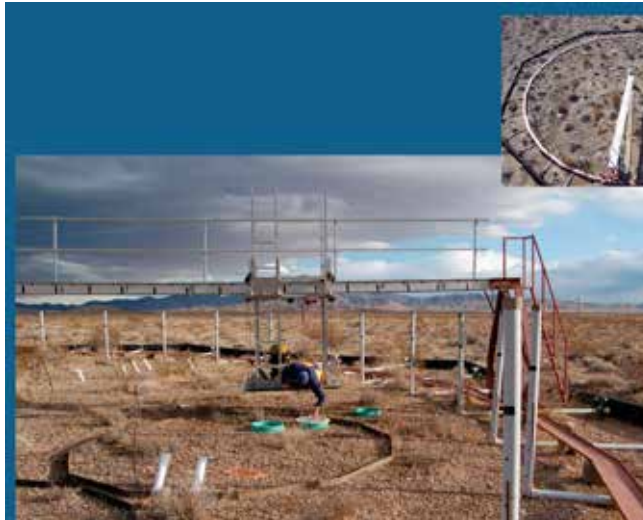
Figura 9.15. Instalaciones en el desierto de Nevada para estudiar el efecto de concentraciones elevadas de bióxido de carbono en la atmósfera. En el recuadro la instalación completa, y uno de los cuadrantes experimentales (Nevada Desert Research Center FACE Facility. Fotografía del recuadro de Stephen Zitzer, la fotografía principal de Lynn Fenstermaker, cortesía de Stanley Smith).
