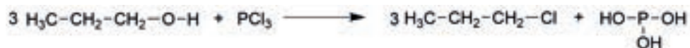
Esquema 3.33 Ejemplo de la formación de cloruro de n -propilo, empleando tricloruro de fósforo.
