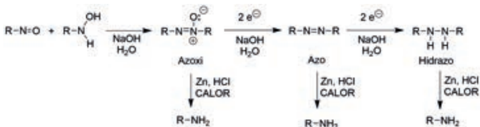
Esquema 5.103 Reducción con Zn, HCl de todos los derivados para formar la amina primaria correspondiente.
