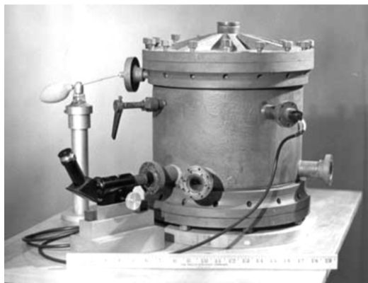
Ilustración 8. Ésta es "la cubeta" en la que Millikan desarrolló su experimento de la gota de aceite. En la ilustración 9 está la figura que empleó de su interior.
