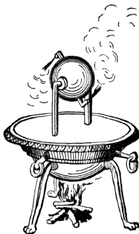
Figura 18.1: La eolípila construída por Herón de Alejandría.
