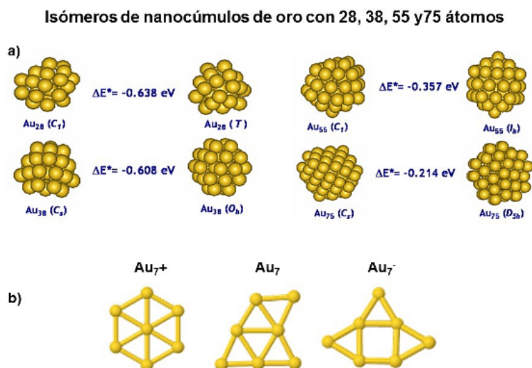
Figura 41.1: (a) Isómeros de nanocúmulos de oro: \text{Au}_{28} , \text{Au}_{38} , \text{Au}_{55} y \text{Au}_{75} . Se muestra la diferencia en energía, en eV, entre las 2 estructuras de más baja energía. Para n = 55 y 75 , el isómero de mayor energía tiene simetría rotacional de orden 5, icosaedrales y decaedrales, respectivamente. Para cada isómero se indica el grupo de simetría puntual de su estructura. (b) Estructuras más estables del nanocúmulo de oro con 7 átomos: de izquierda a derecha: catión, neutro y anión.
