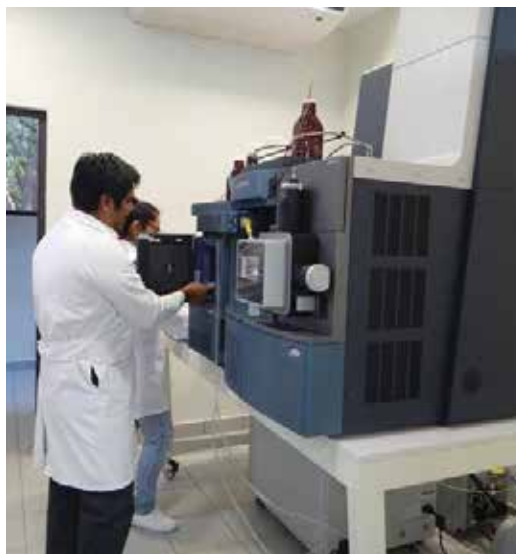
Cromatógrafo de líquidos de ultra alta definición acoplado a un Espectrómetro de masas. Lab. de Biotecnología. UTM. Huajuapán de León.
