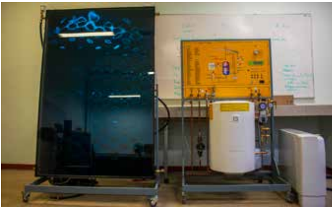
Entrenador de energía solar térmica con panel real y simulado. Campus Tehuantepec
