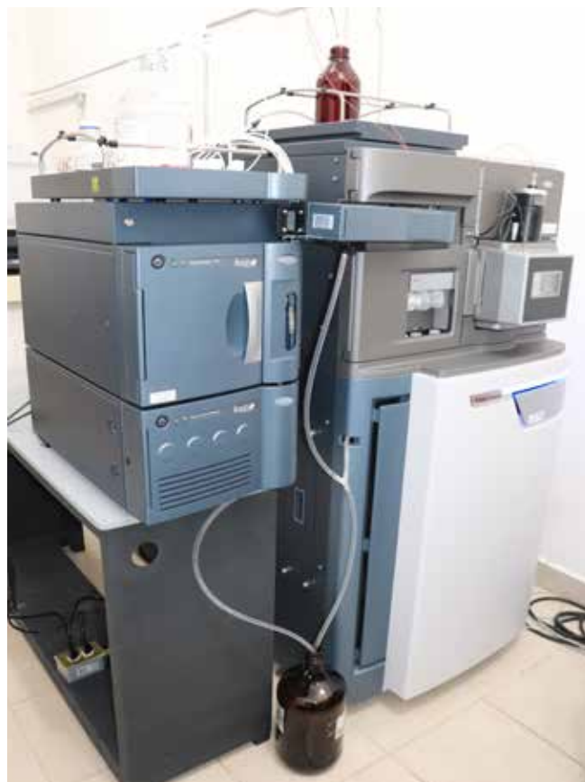
Espectrómetro de Masas de alta resolución. Lab. de Espectrometría de Masas. UNPA. Campus Tuxtepec
