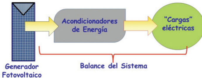
Figura 1.1: Diagrama esquemático de un Sistema Fotovoltaico.
