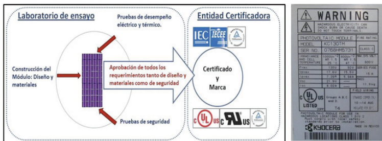
Figura 4.9: Esquema y pruebas que debe satisfacer un MFV para su certificación y un ejemplo de una etiqueta de identificación con el sello UL.
