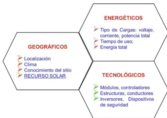
Figura 5.3: Factores importantes a conocer para realizar el proceso de dimensionamiento fotovoltaico
