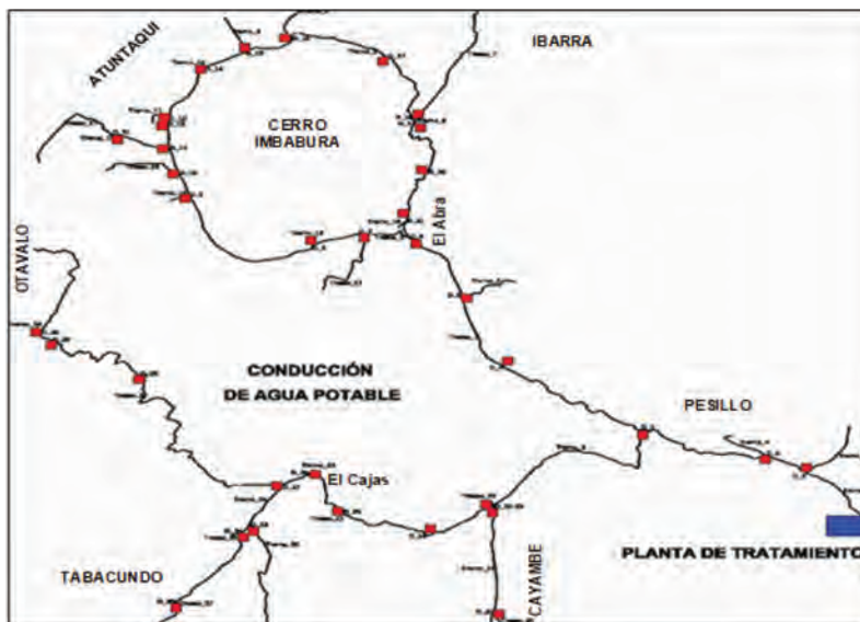
Figura 29 Líneas de conducción y distribución de agua (en puntos rojos los tanques de almacenamientos y distribución de las regionales)
