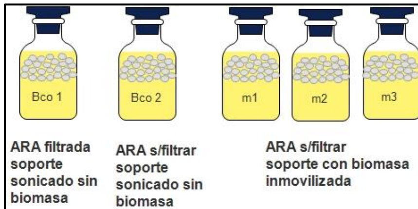
Figura 5. Diagrama de Actividad Ureolítica Específica de la biomasa inmovilizada en el soporte. ARA: agua residual amarilla.
