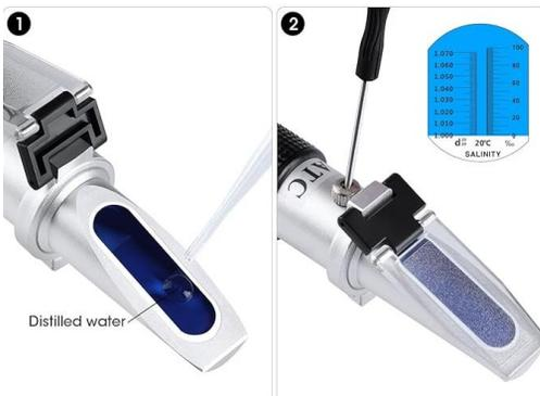
Calibración a cero de salinidad
