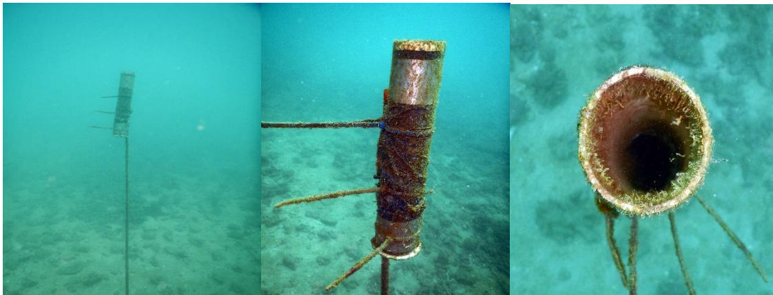
Figura 6. Trampas de captura de sedimentos suspendidos utilizados en Isla Montosa y bahía La Entrega, Huatulco, Oaxaca
