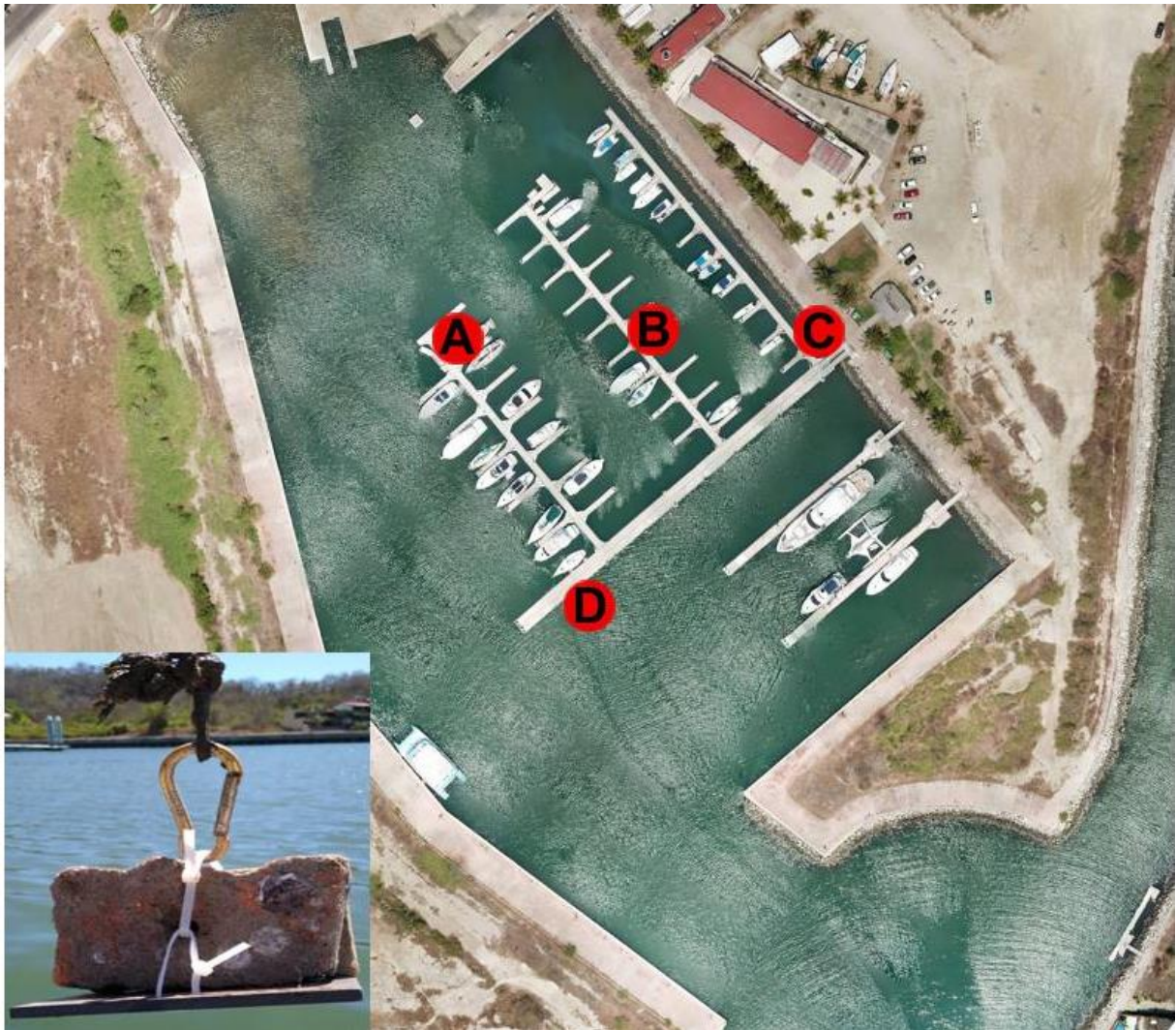
Figura 7. Estaciones de instalación de las placas en la marina Chahué (cortesía del SIG, UMAR); placa de PVC armada para la bioincrustación de invertebrados.
