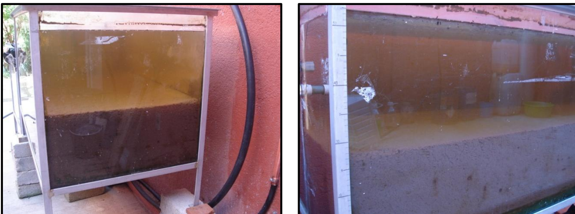
Figura 10. Proceso de sedimentación del reactor después de un tiempo de retención hidráulico de 45.6 h.
