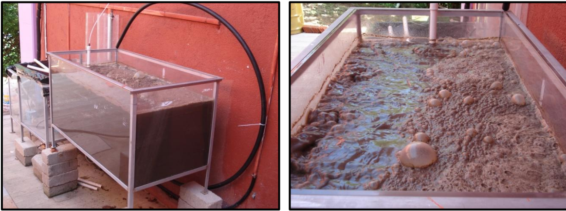
Figura 9. Reactor biológico de lodos activados operado en lote secuencial.
