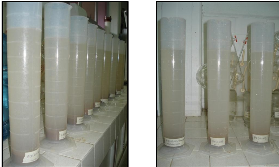
Figura 36. Determinación de la clase textural del suelo por el Método del Hidrómetro de Bouyoucos.
