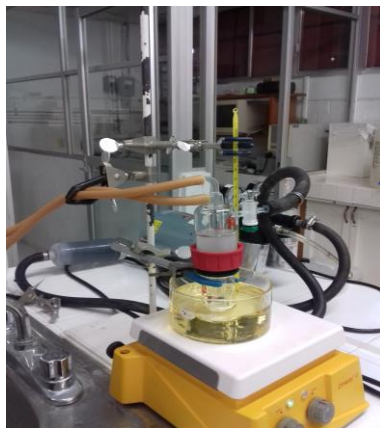
Figura 12. Equipo de sublimación utilizado para la purificación del 14BisDAB y el TFB.
