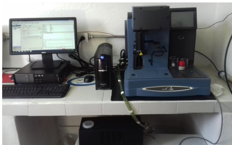
Figura 13. Equipo TGA Q500 de TA Instrument usado para determinar la \Delta_{\text{vap}}H .
