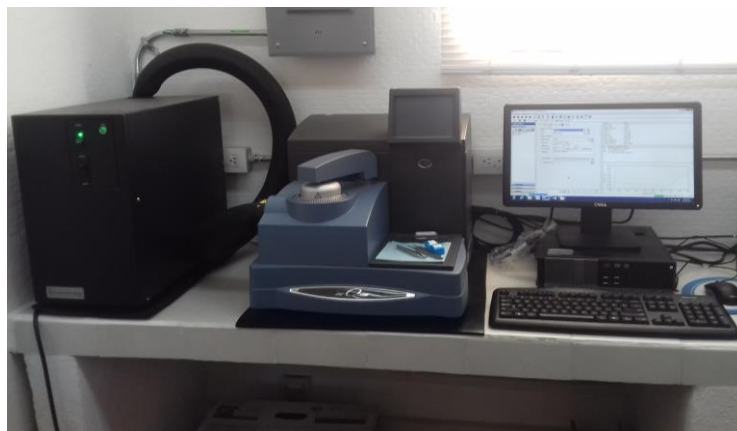
Figura 10. CDB Q2000 de TA Instrument empleado para determinar la x , T_{\text{fus}} y \Delta_{\text{fus}}H^\circ .
