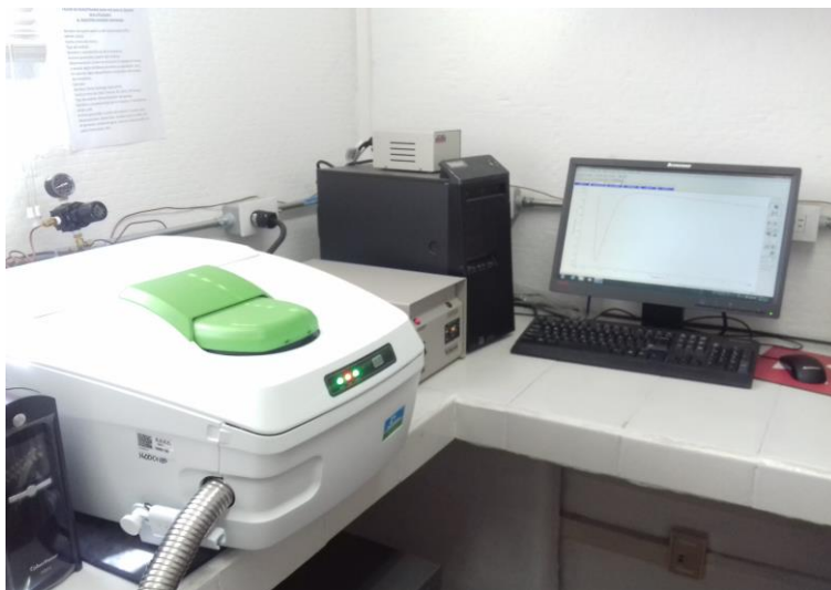
Figura 11. CDB 8000 Perkin Elmer empleado para determinar la C_p .
