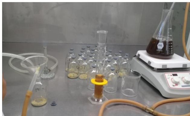
Figura 8. Preparación de biodigestores.
