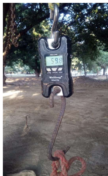
Figura 4. Báscula digital colgante utilizada en el pesaje las unidades experimentales.
