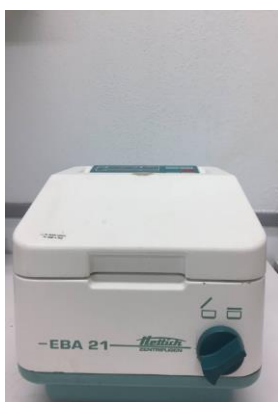
Centrifugación a 6 000 rpm/15 min
